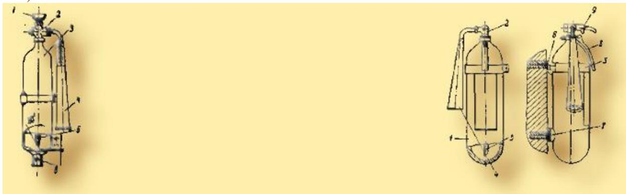
**Рис. 1. Ручной углекислотный огнетушитель ОУ-2:**
